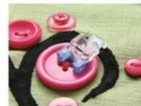
ATTENTION : vérifiez avec le volant que l'aiguille ne s'appuie pas sur le bouton.
