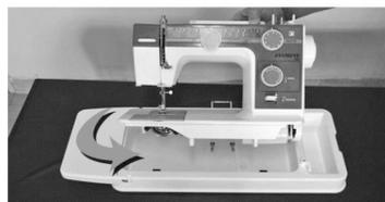
5. Verrouiller le dispositif de retenue.
